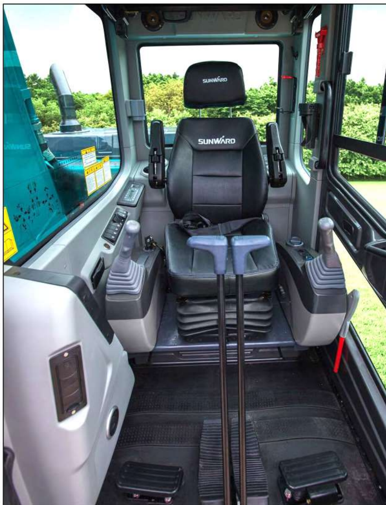
Assento com suspensão ajustável, foi projetado para atender as exigências de diferentes alturas e pesos dos operadores.
