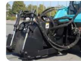
Fresadora de asfalto
