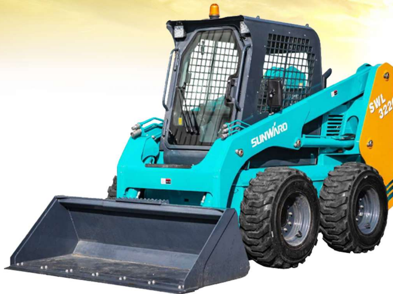
SWL 3220 MINI CARREGADEIRA Potência líquida do motor: 55,4 Kw Peso da máquina: 3.450 kg
