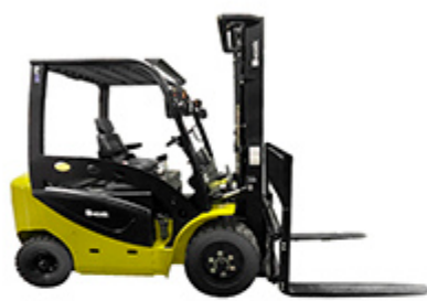
Empilhadeira Contrabalançada com motor elétrico e com tração de corrente alternada (AC).
